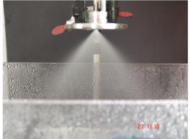
Figura 15. Injetor jato-centrífugo operando na condição de trabalho.
